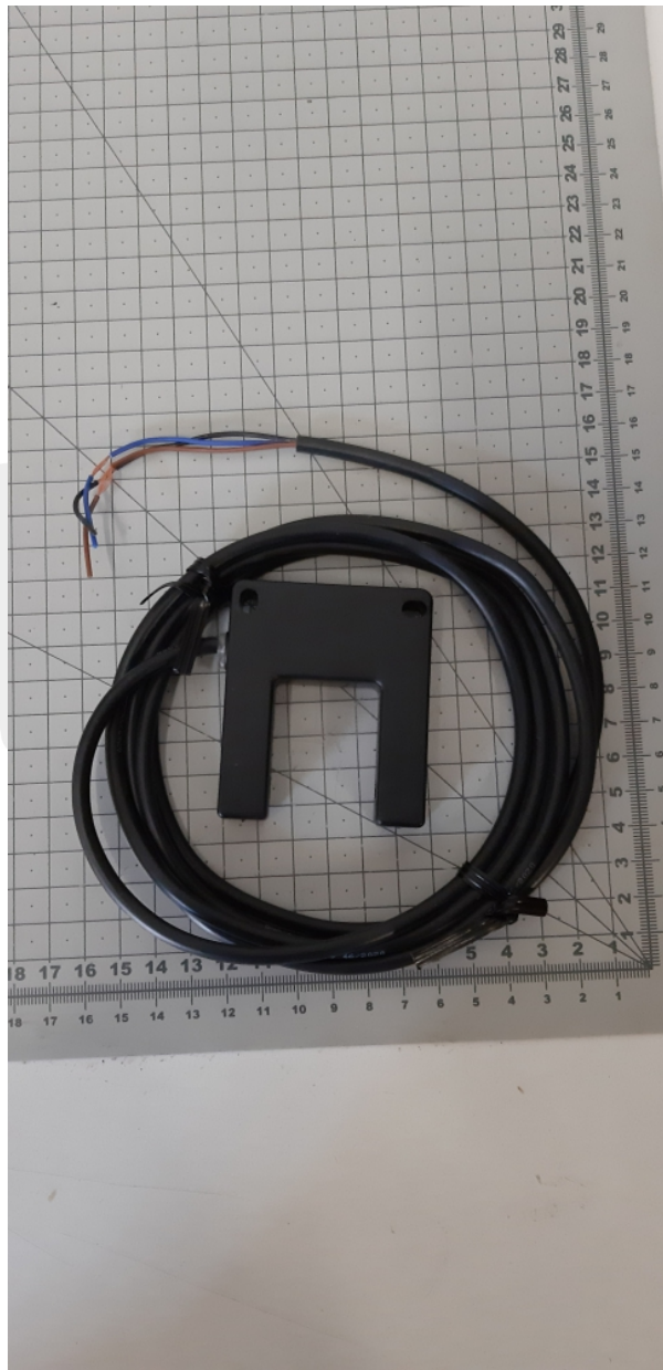
0002-00000-50966 Czujnik fotoelektryczny Sn=30mm 24V XUVH031
