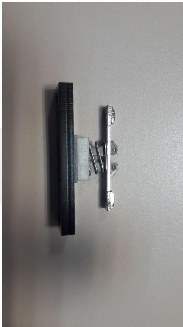
Zwora kontaktu TKS-F drzwi szybowych Macuparsa
